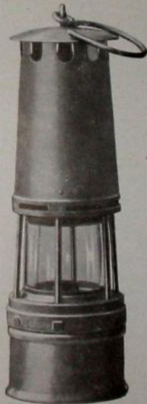
Lampe à essence " ARRAS " type M Fermeture magnétique, rallumeur à commande verticale
